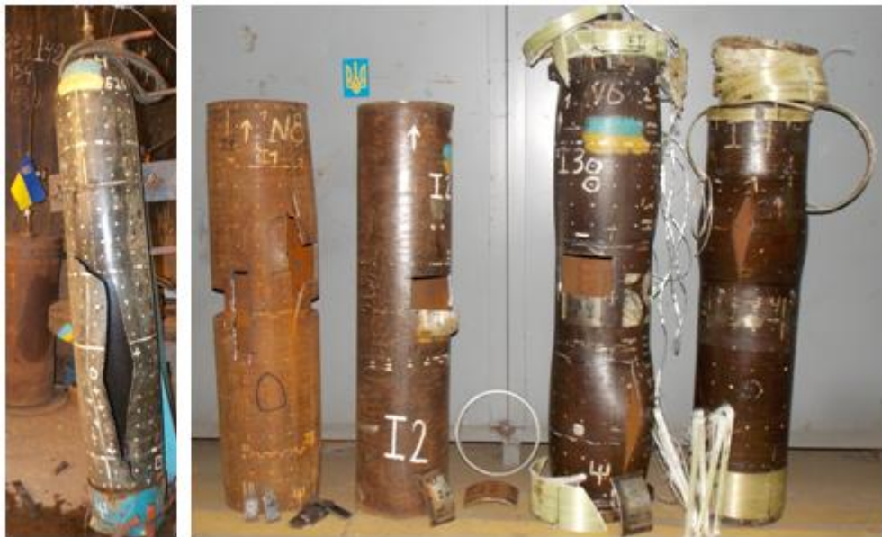
Кислородный 40-ка литровый баллон и экспериментальные образцы после испытаний.
