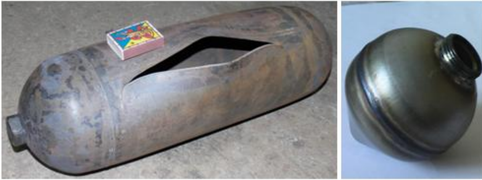
Производимые в лаборатории штампосварные баллоны: объемом 5 и 0,3 л.
