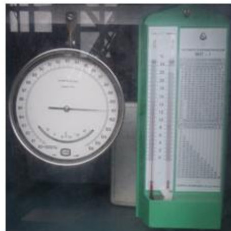
Блок для контроля давления, температуры и влажности воздуха
