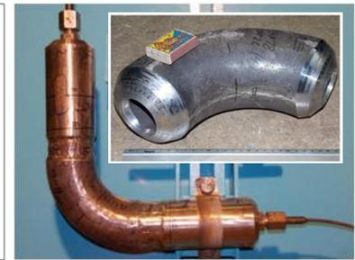
Рис. Пример нагружения пробным давлением.
