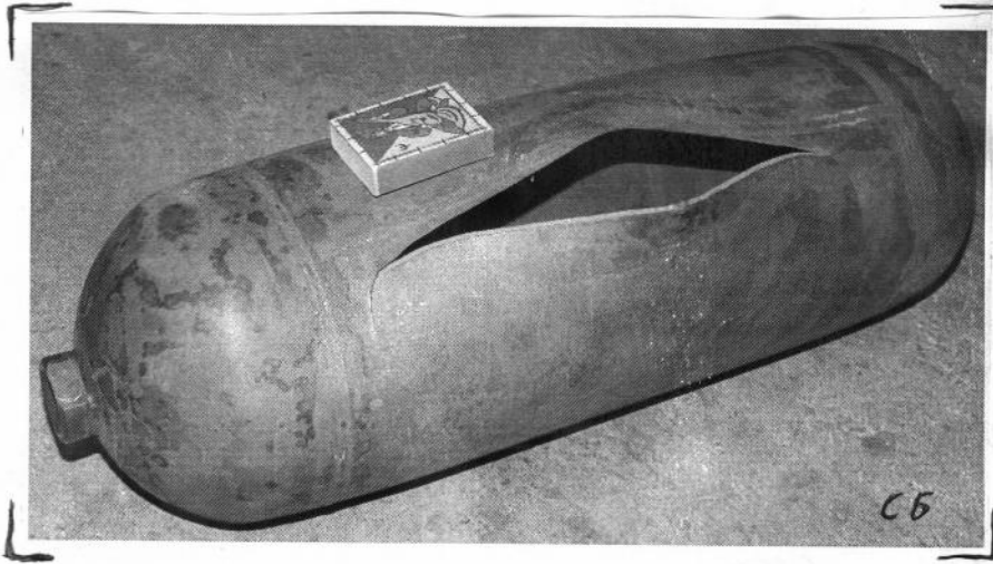
Фото. Штампованной цилиндрический баллон „СБ“ после гидроиспытаний статическим давлением до разрушения.
