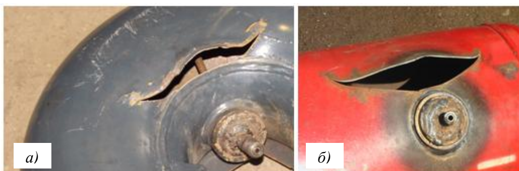
Рис. 13. Ввариваемый специальный штуцер при испытании автомобильных баллонов до разрушения:
