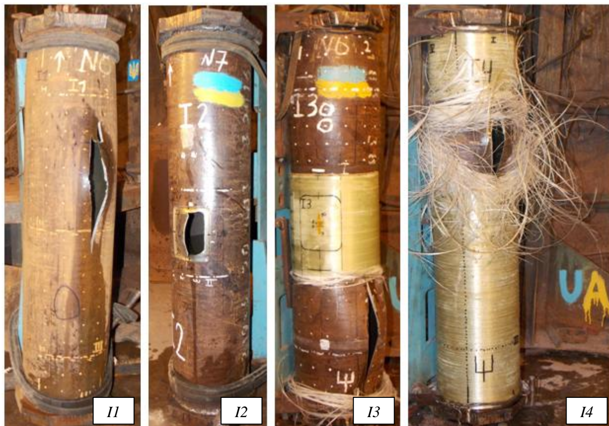
Рис. 7. Натурные образцы I1, I2, I3 и I4 после их разрушения внутренним гидравлическим давлением. (Образцы закреплены в стенде).
