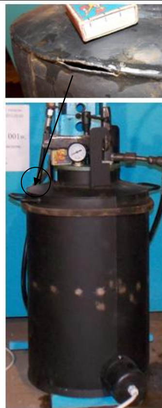
Фото об'єкту після випробувань.
