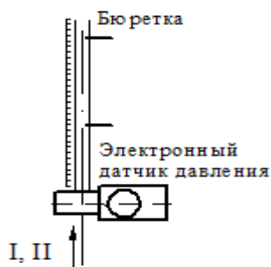
Фиг. 4 - Дополнения к схеме установки для испытаний баллонов, представленной на фиг. 3.
