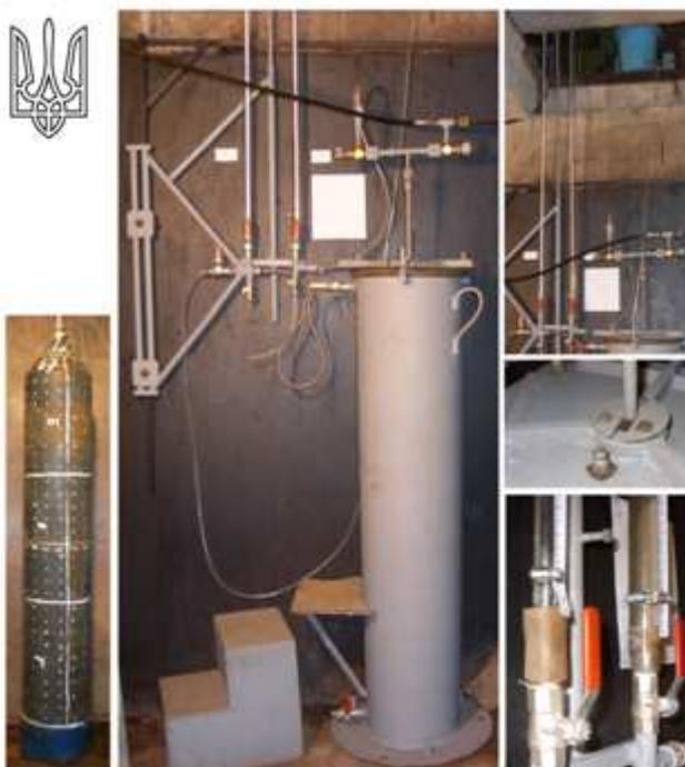
Рис. 2 Принципиальная схема и фото установки: «Водяная рубашка», реализованной в ИЭС им. Е. О. Патона, для испытаний баллонов на остаточное расширение. (А В - бюретки).
