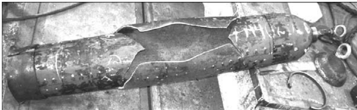
Рис. 3. Общий вид кислородного баллона Б20 после его разрушения избыточным давлением
