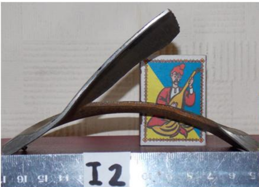
Рисунок 5 - Фото образца I2 после разрушения, (этап № 12), и сечение дефекта после вырезки.
