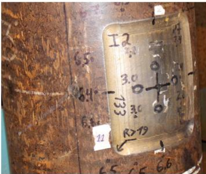
Рисунок 3 - Фото дефекта образца I2 после нагружения давлением 11,78 МПа, (этап № 10).
