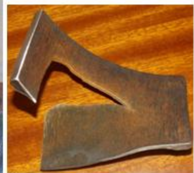
Рисунок 5 - Фото образца I2 после разрушения, (этап № 12), и сечение дефекта после вырезки.
