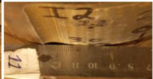
Рисунок 4 - Фото дефекта образца I2 после нагружения давлением 13,49 МПа, (этап № 11, предпоследний).
