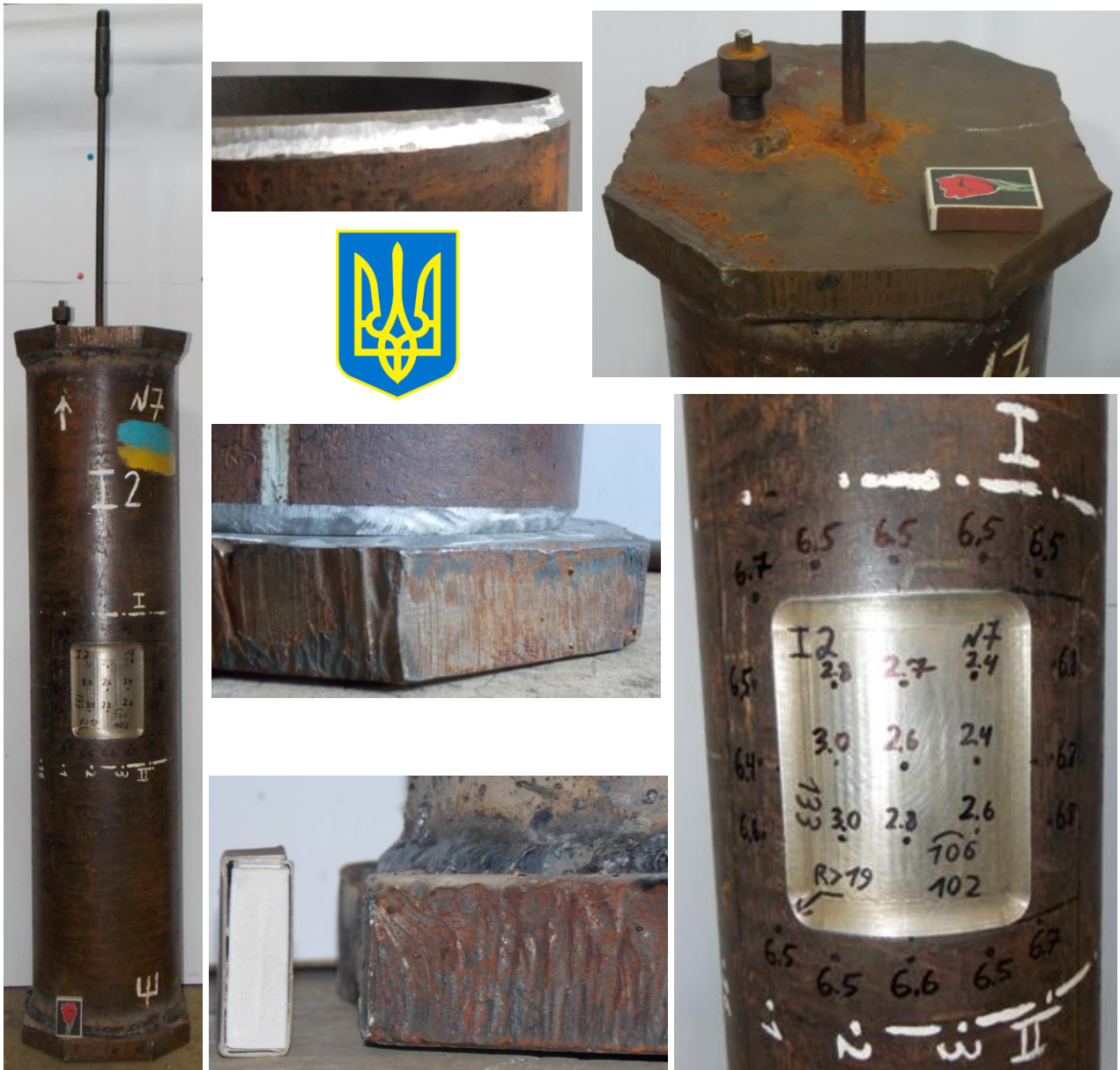
Рисунок 2 - Фото образца I2 и дефекта нанесенного на нем.
