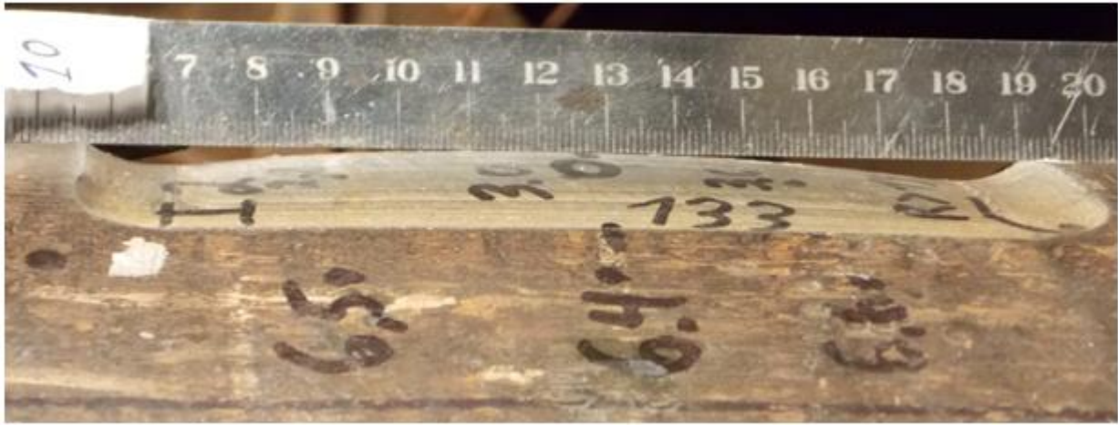
Рисунок 3 - Фото дефекта образца I2 после нагружения давлением 11,78 МПа, (этап № 10).
