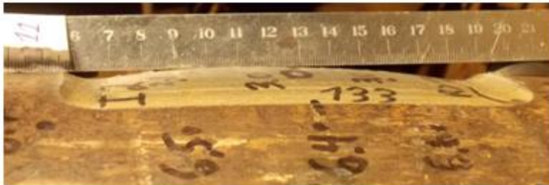
Рисунок 4 - Фото дефекта образца I2 после нагружения давлением 13,49 МПа, (этап № 11, предпоследний).
