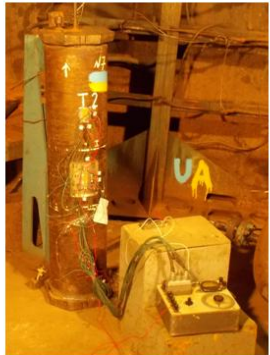
Рисунок 2 - Фото образца I2 с установленными на него тензорезисторами, (т/р).
